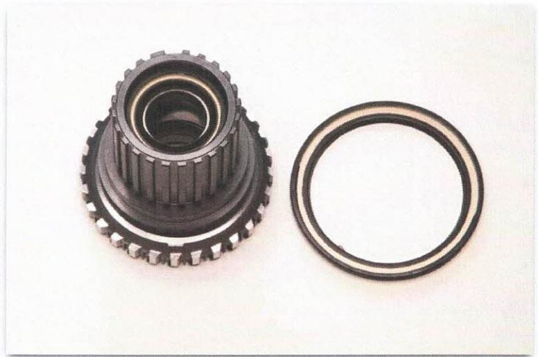
Entfernen Sie den Spacer.
