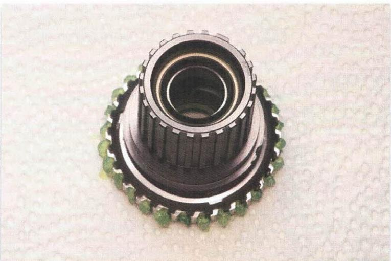
Montieren Sie den Freilaufkörper. Stellen
