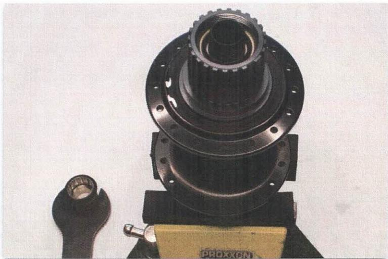
Den C-Ring mit der Sicherungsringzange entfernen
