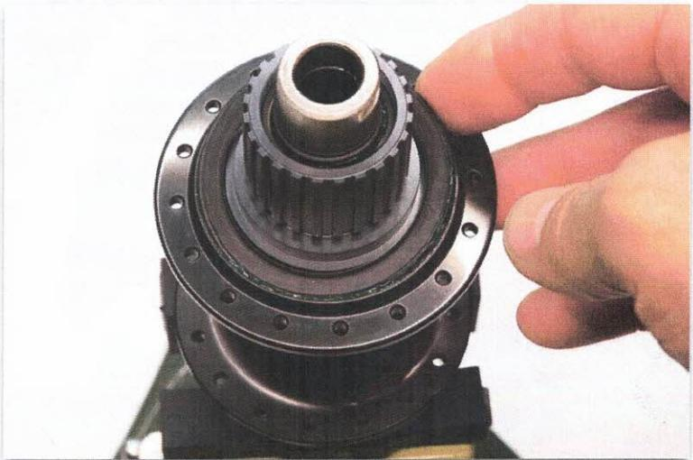
Verwenden Sie zur Montage des Dichtrings das Werkzeug TL-FH16.
